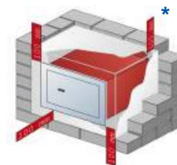
**Le coffrage en béton protège contre l'arrachage du coffre-fort mural. Le coffre-fort doit être entouré d'une couche de béton de 100 millimètres d'épaisseur de tous les côtés.**
