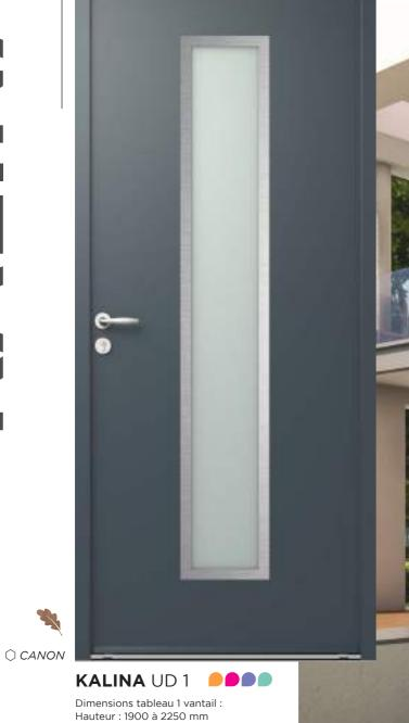
Dimensions tableau 1 vantail : Hauteur : 1900 à 2250 mm Largeur : 700 à 1100 mm Triple vitrage Affleurant Dépoli Décor alu. anodisé brossé Poignée rosace E16R
