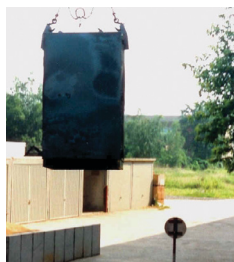
chute d'une hauteur de 9,15 m
